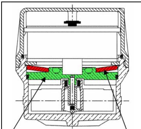
Esquema del interior del contador de chorro único anti-hielo, donde la pletina intermedia permite el aumento del volumen del agua en el interior del contador.
